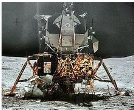
Рис. 2. Лунный корабль (модуль).
